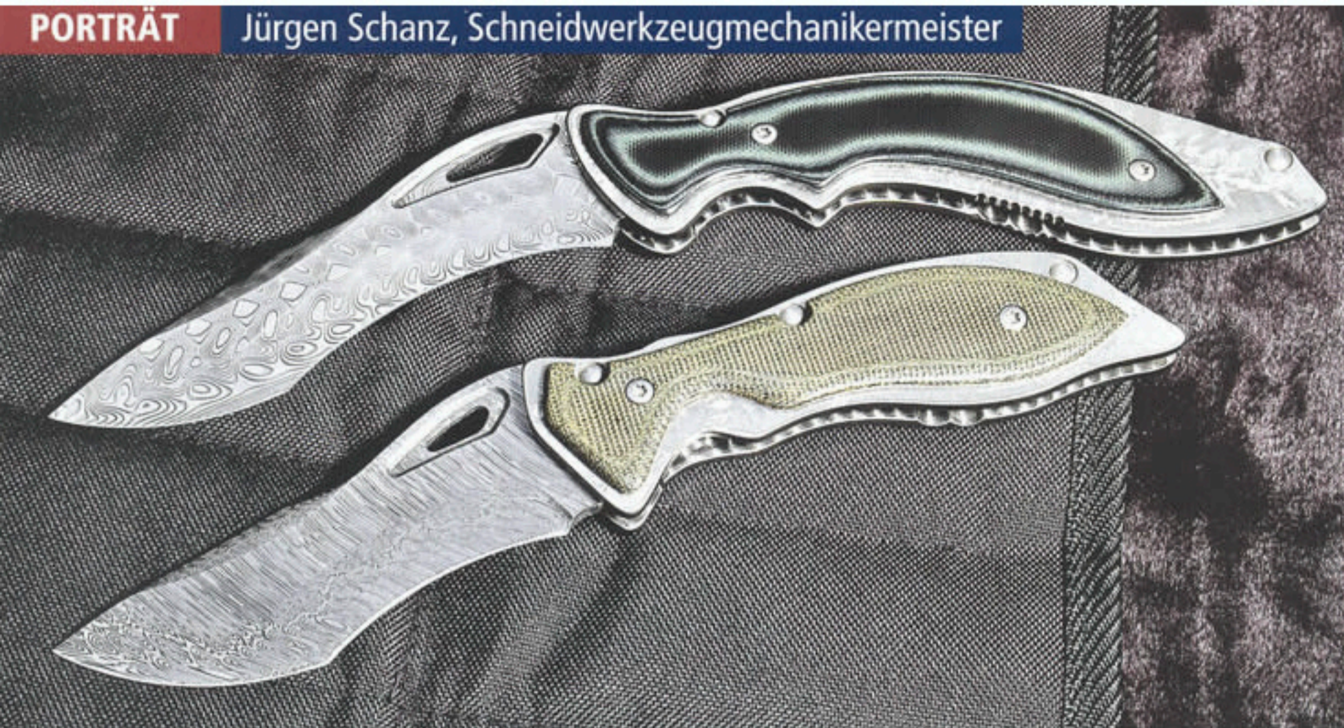
WILDES PAAR: „Killa-Banane“ (oben) und die kleinere Version „Aggroputo“, beide mit Damastklinge und allen übrigen Metallteilen in Titan.
